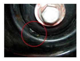
3) 在 BC 避震器後彈簧調整上座的邊緣,有個缺口。在 安裝時,此缺口需對應焊接突出點。
