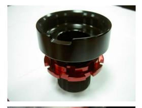
4) 當安裝 BC 避震器彈簧調整上座時,需確認上緣的缺 口需對應到車體的焊接突出點。這樣才能確保避震器 使用的安全和穩定性。
